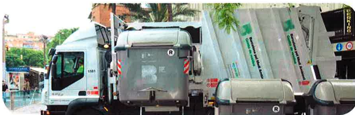
Proceso de vaciado de contenedor mediante carga lateral
