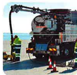
Vehículo de aspiración-impulsión para el mantenimiento de la red de alcantarillado
