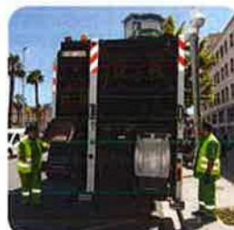
Recogida orgánica y de resto mediante vehículo bicompartimentado
