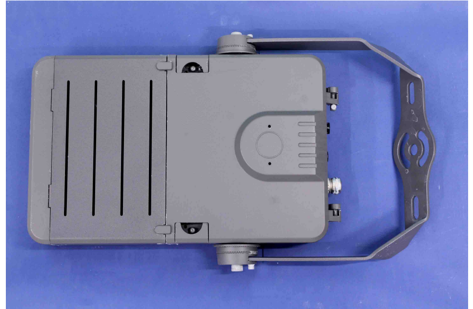
Figura 4. (1500 horas). Nivel de corrosión que presenta la pieza tras el ensayo. Figure 4. (1500 hours). Corrosion level of the part after the exposure time.
