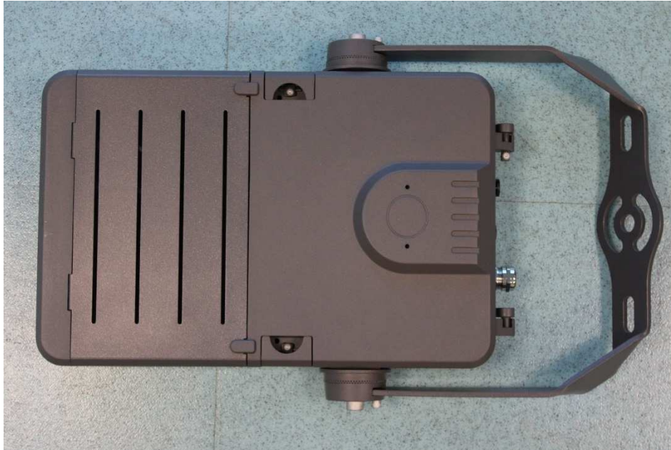
Figura 3. Aspecto que presenta la pieza antes del ensayo de niebla salina. Figure 3. Appearance of the part before the salt spray test exposure.
