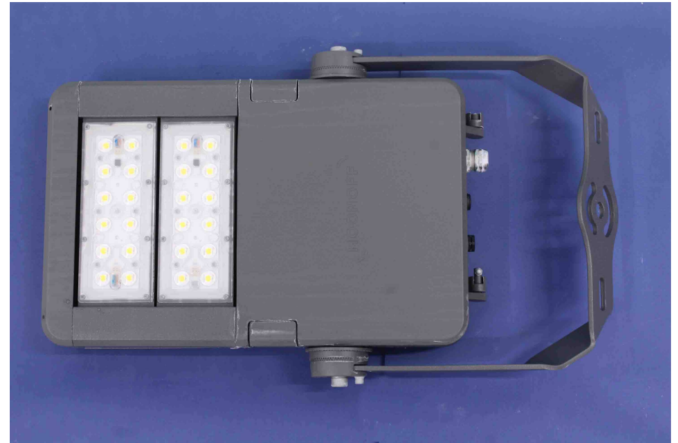
Figura 2. (1500 horas). Nivel de corrosión que presenta la pieza tras el ensayo. Figure 2. (1500 hours). Corrosion level of the part after the exposure time.
