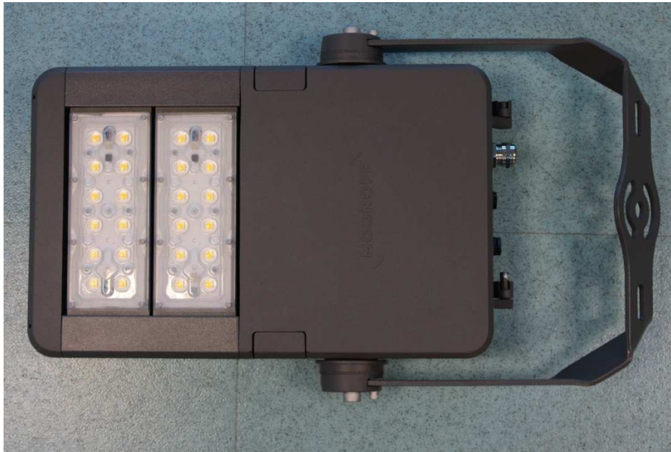
Figura 1. Aspecto que presenta la pieza antes del ensayo de niebla salina. Figure 1. Appearance of the part before the salt spray test exposure.
