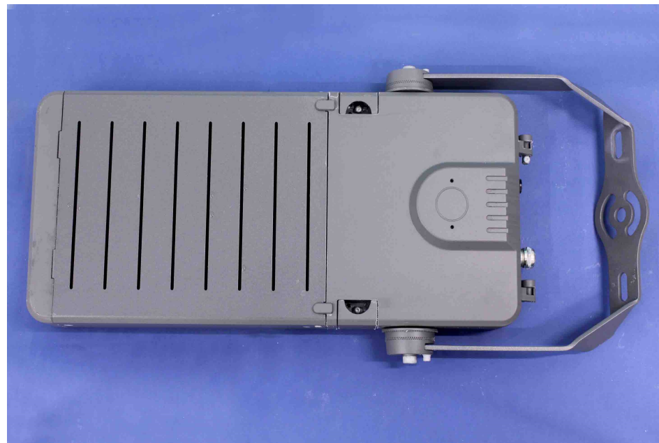
Figura 4. (1500 horas). Nivel de corrosión que presenta la pieza tras el ensayo. Figure 4. (1500 hours). Corrosion level of the part after the exposure time.
